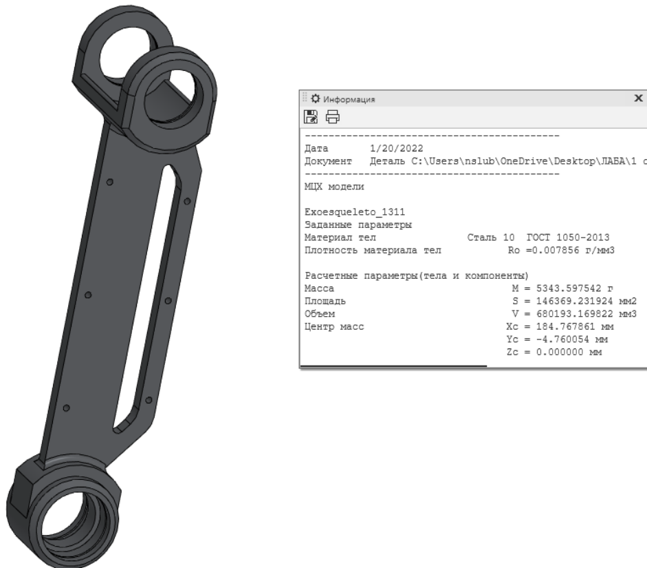
Рис. 8. Массово-центровочные характеристики детали «рычаг»
